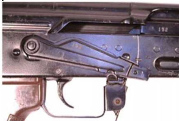
Obrázek 7. Páka voliče v poloze pro střelbu jednotlivými výstřely.
