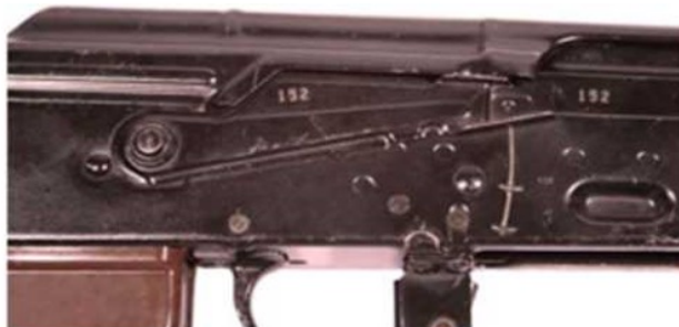
Obrázek 6. Páka voliče v zajištěné poloze.
