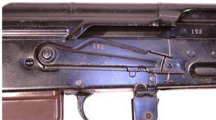
Obrázek 8. Páka voliče v poloze pro střelbu dávkou.
