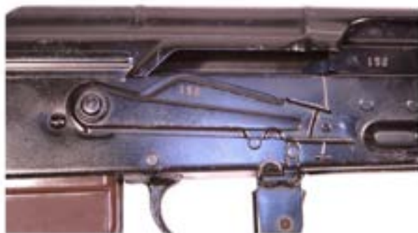
شکل 8. اهرم انتخابگر روی "خودکار" قرار گرفته است
