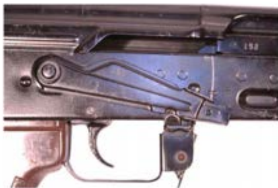
شکل 7. ضامن در وضعیت نیمه خودکار
