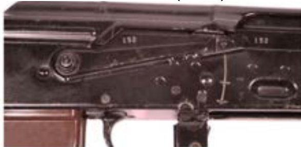
شکل 6. اهرم انتخاب در شرایط ایمن قرار گرفته است
