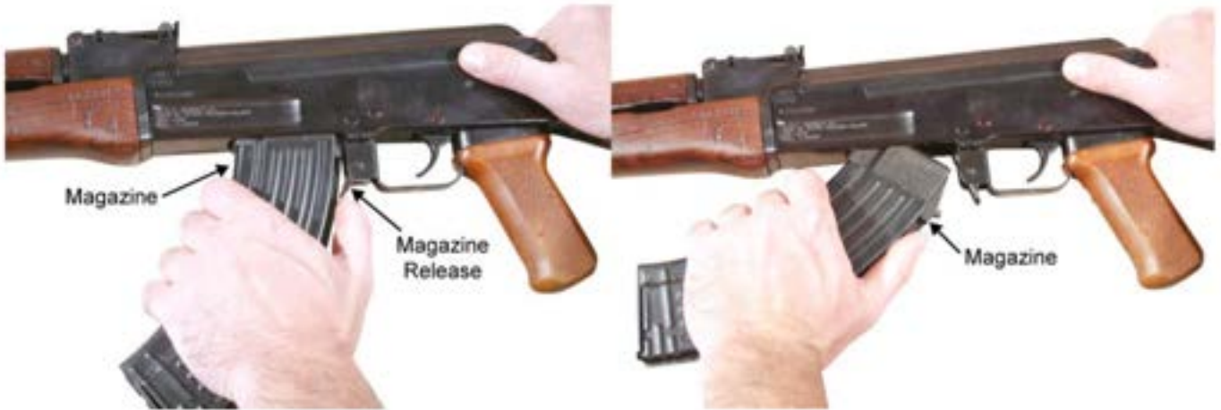
شکل 2. خارج کردن خشاب
